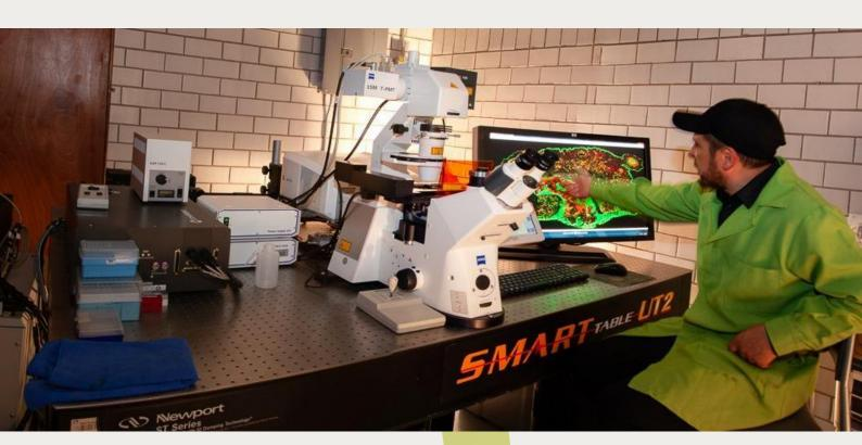
Sistema de microscopia confocal de bar<mark>rido láse</mark>r, espectral multifotónico marca Carl Zeiss modelo LSM 780 NLO equipa<mark>do con 3</mark>2 fotomultiplicadores GAASP y 2 fotomultiplicadores PMT FL. Detector de <mark>luz trans</mark>mitida
