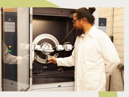
Es un equipo de difracción de rayos X para muestras policristalinas sólidas y líquidas en configuración theta-theta, con óptica Twin Bragg-Brentano (divergente) y haces paralelos (espejo multicapas y rendija ecuatorial larga de 0.2° de tipo Soller).
