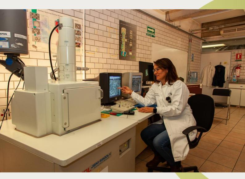
El microscopio electrónico de barrido marca JEOL (JSM-5900LV) permite realizar estudios a partir del análisis morfológico superficial, mediante la obtención de imágenes de electrones secundarios (SEI), así como, la realización de análisis mediante imágenes de electrones retrodispersados (BSE) y también es una herramienta auxiliar para conocer la composición química elemental de las muestras en estudio por espectroscopia de energía dispersiva de rayos X (EDS).
