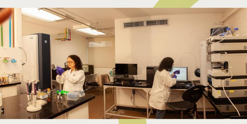
Con Cromatógrafo de alta resolución (UHPLC) marca Thermo Scientific, modelo Dionex Ultimate 3000 acoplado al espectrómetro ESI-MS. Incluye: automuestreador MCA, Bomba MCA, detector de arreglo de diodos DAD-3000, detector de fluorescencia FLD-3100, rack para posicionar fases móviles.
