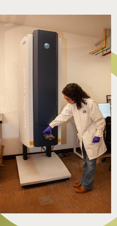
Espectrómetro de masas con fuente de ionización por láser asistida por matriz, con analizador de tipo Tiempo de vuelo (TOF). Adecuado para la determinación de masas de macromoléculas, y capacidad de fragmentación (MS-MS).
