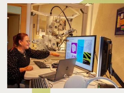
Se cuenta con dos portamuestras: uno de calentamiento hasta 800°C y otro de enfriamiento que puede alcanzar una temperatura de -160°C, teniendo la oportunidad de grabar en video las transformaciones de fase por temperatura in situ o más allá, para materiales que solamente a bajas temperaturas son sólidos y tener así el ambiente para poder observarlas.
